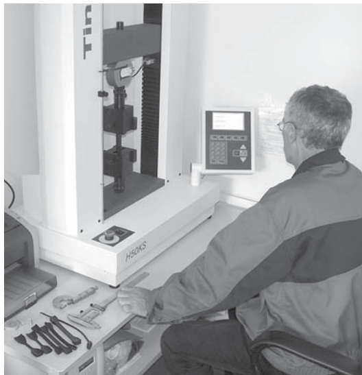
Фото 4.2.8. Испытания стыковых сварных соединений в лаборатории ИКАПЛАСТ
