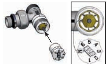
2. Установить ключ регулировки (есть в упаковке) на шток клапана таким образом, чтобы буква N на ключе совпала с буквой N на клапане.
