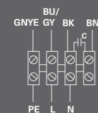
Схема 1 (230 В, 1 ф.)
