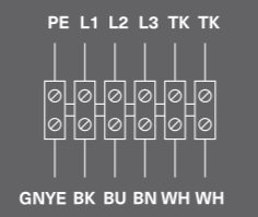
Схема 5 (▲ — 400 В, 3 ф.)
