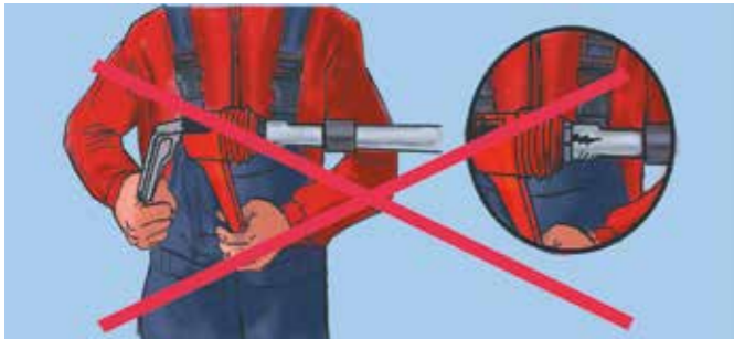
Однократное резкое расширение трубы со сведением ручек расширителя до упора
