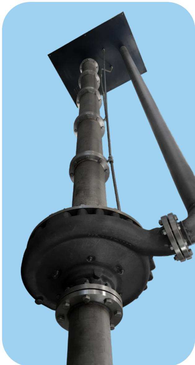
Вертикальные одноступенчатые полупогружные насосы с закрытым рабочим колесом. Используются для подачи различных жидкостей из емкостей и приемков. Насос предназначен для стационарной установки.
