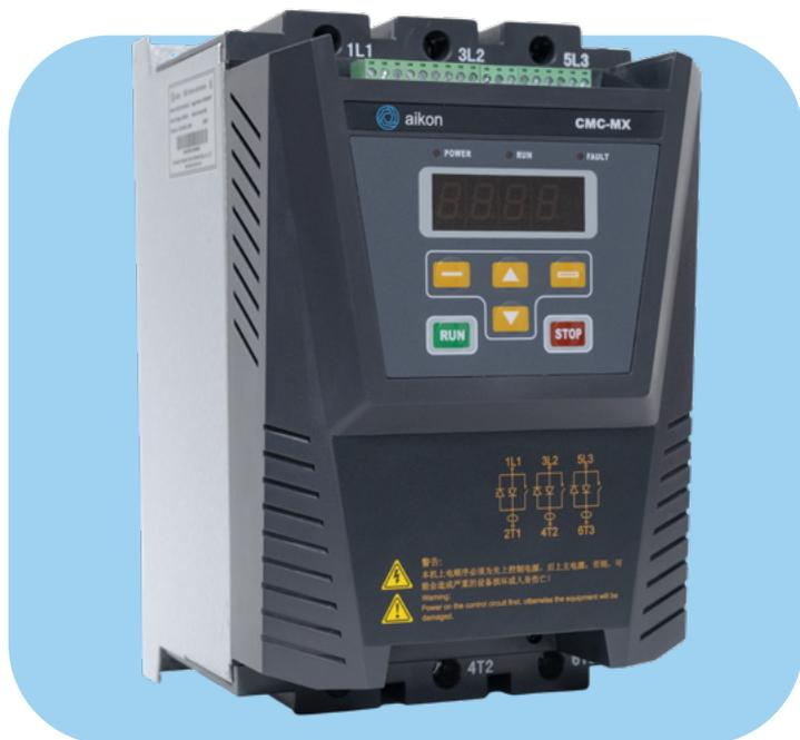
Устройства плавного пуска СМС-МХ используются для управления процессом запуска и остановки электродвигателя. Применение СМС-МХ ограничивает пусковые токи, снижает вероятность перегрева и устраняет стартовые рывки электродвигателя, что в итоге, повышает срок эксплуатации всего связанного технологического оборудования.
