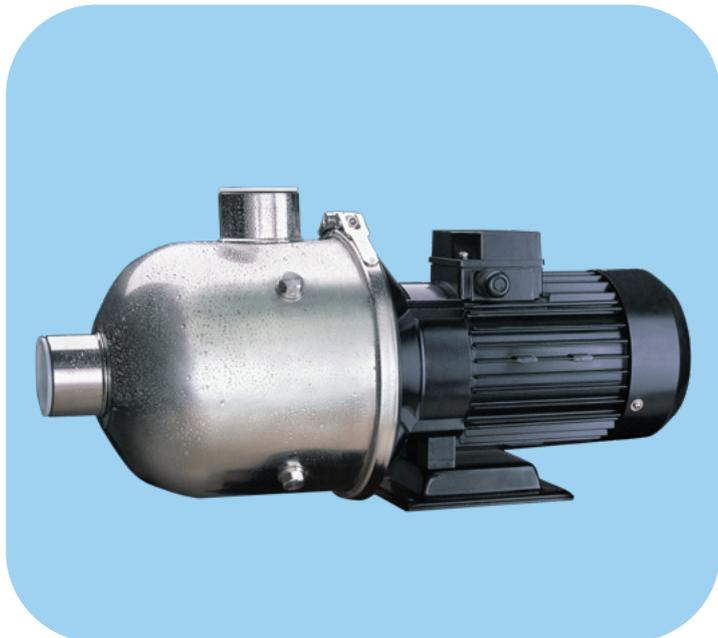
Горизонтальные многоступенчатые центробежные насосы с осевым всасывающим и радиальным напорным патрубками. Корпус и рабочее колесо изготовлены из штампованной листовой нержавеющей стали.
