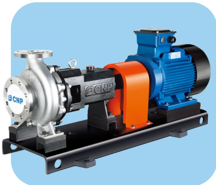
Горизонтальные одноступенчатые химические консольные насосы. Широкий диапазон типоразмеров, соответствует стандарту ISO 2858. Камера уплотнения сконструирована в соответствии со стандартом API 682, предусмотрена возможность присоединения планов обвязки торцевого уплотнения для специальных рабочих условий.
