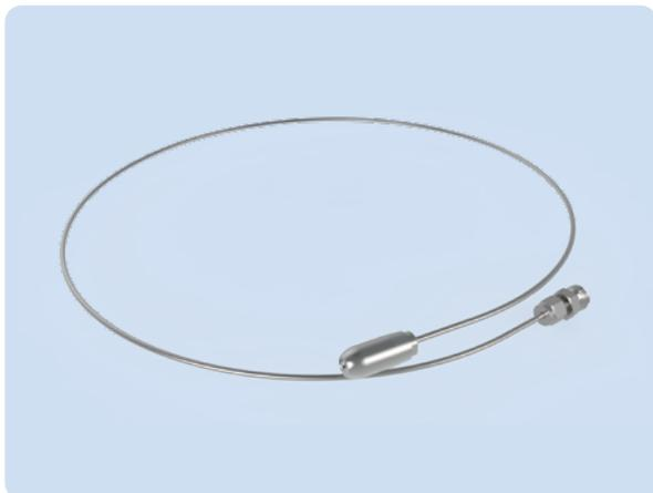
Пассивная форсунка подключается к отводу от магистрали высокого давления. В модели PN1SS имеется участок трубки из нержавеющей стали, которая позволяет аккуратно вывести распыляющую головку из стены или потолка. В состав пассивной форсунки не входит регулирующий электромагнитный клапан, поэтому форсунка распыляет воду пока в магистрали есть высокое давление. Все форсунки, подключенные к одной магистрали, работают синхронно.
