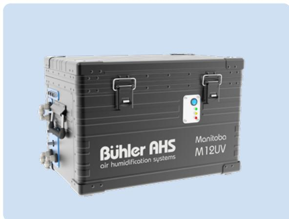
Основной элемент системы **Manitoba 12**. Включает двухступенчатый обратный осмос, ультрафиолетовый стерилизатор, насосный блок высокого давления, гидравлическое оборудование, автоматику и сенсоры. Чистит питающую воду, поддерживает высокое давление в магистральной линии, обеспечивает функции автоматической работы и безопасности. Подключается к питающей воде, канализации, к коннекторам магистрали высокого давления. Работает совместно с зональным контроллером MZC10RF.
