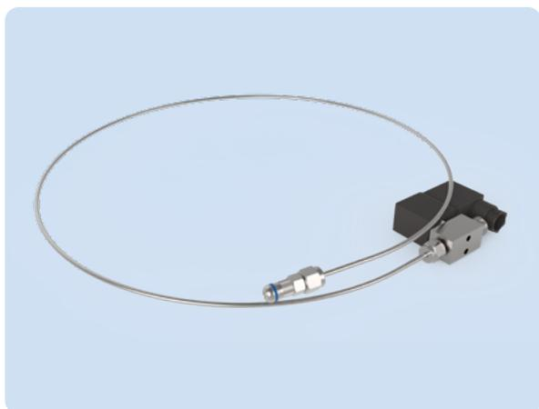
Активная форсунка подключается к отводу от магистрали высокого давления. В состав активной форсунки входит регулирующий электромагнитный клапан высокого давления для возможности управления подачей распыляемой воды индивидуально для данной форсунки.
