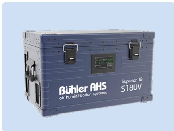
Основной элемент системы **Superior 18**. Включает в себя систему обратного осмоса с двумя последовательно включенными мембранами, накопительную емкость с ультрафиолетом, гибридную насосную систему высокого давления SEPAMED, блок автоматики с сенсорной панелью управления, необходимые для работы сенсоры и вентили.
