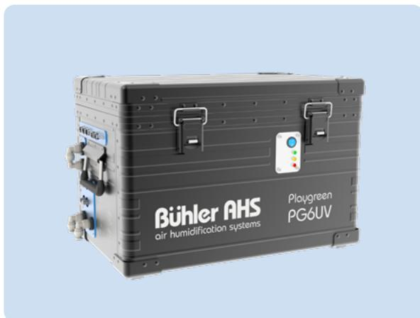
Основной элемент системы **Playgreen 6**. Включает двухступенчатый обратный осмос, ультрафиолетовый стерилизатор, насосный блок высокого давления, гидравлическое оборудование, автоматику и сенсоры. Предназначен для очистки питающей воды, нагнетания и независимого поддержания высокого давления в магистральных линиях, обеспечения функций автоматической работы и безопасности.
