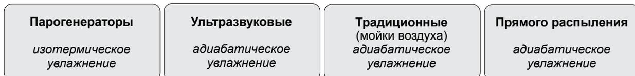
**Изотермическое увлажнение** – добавление в воздух водяного пара, полученного при кипячении воды за счет электроэнергии или газа. Данный способ практически не меняет или несколько увеличивает температуру воздуха.
