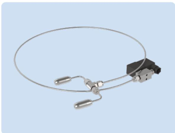
Активная форсунка подключается к отводу от магистрали высокого давления. Данная форсунка имеет спаренные распыляющие головки. В состав активной форсунки входит регулирующий электромагнитный клапан высокого давления для возможности управления подачей распыляемой воды индивидуально для данной форсунки.
