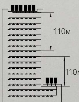
Благодаря использованию технологий полного инверторного управления и технологии переохлаждения хладагента, появляется возможность спроектировать систему с увеличенными длинами трубопроводов и перепадом высот.
