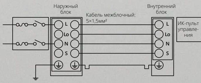
Заземление Кабель электропитания (автоматический выключатель)
