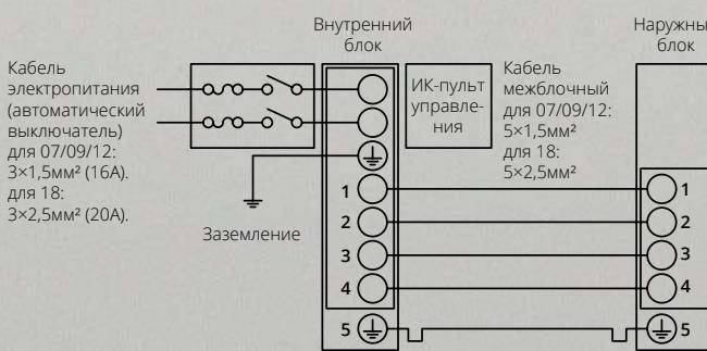
Схема подключения серии Q Light On-Off (24)
