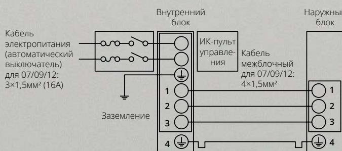
Схема подключения Q Light Inverter (18/24)
