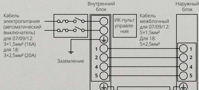
Схема подключения Prime series On-Off (24/36)
