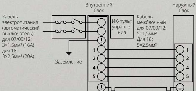
Схема подключения FJ series On-Off (24)
