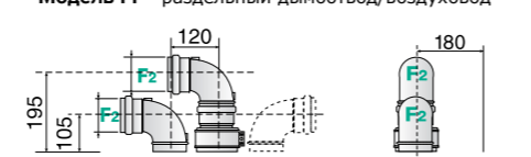
Модель FF - раздельный дымоотвод/воздуховод
