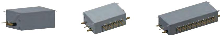
Распределительный блок — это устройство, которое осуществляет управление потоками хладагента в мультизональных системах AMV с рекуперацией тепла. Он позволяет запустить подключаемый к нему внутренний блок в любом режиме, независимо от того, в каком режиме работают другие внутренние блоки этой мультизональной системы.
