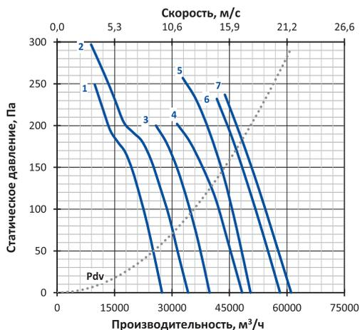
**№11,2. Диаметр обечайки 1120 мм**
