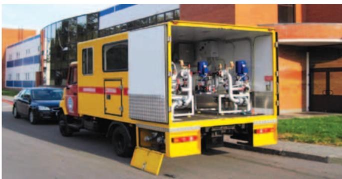
**Станция аварийного водоснабжения на базе автомобиля**
