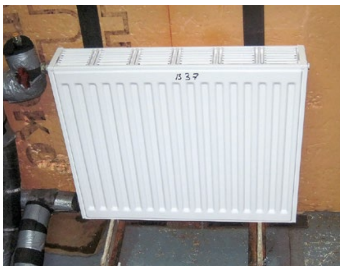
Рис. 2. Радиатор 22-500-600 в камере испытательного стенда (стандартные боковые панели)
