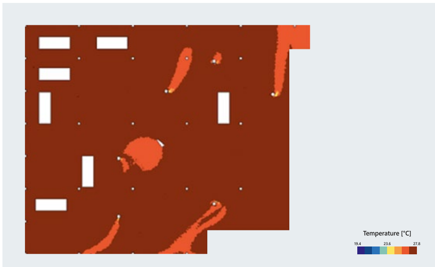
•• Рис. 2. Поле температур в горизонтальном сечении помещения
