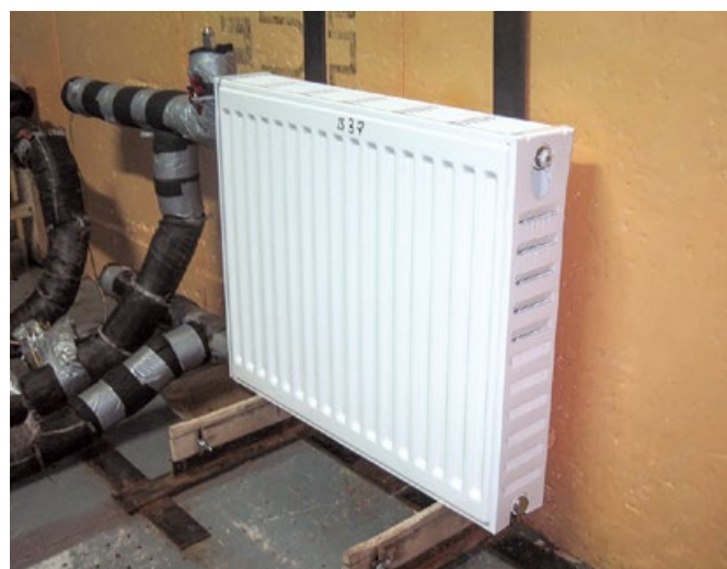
Рис. 3. Радиатор 22-500-600 в камере испытательного стенда с боковыми панелями, имеющими конвективные окна (вариант I)
