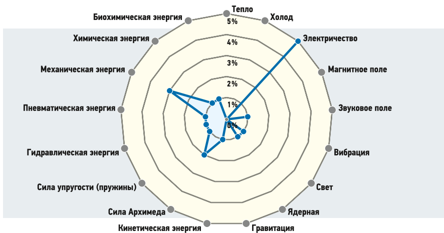
•• Рис. 1. Физико-химические принципы измерения температуры, доступные для применения в компактных приточно-вытяжных установках с роторным рекуператором
