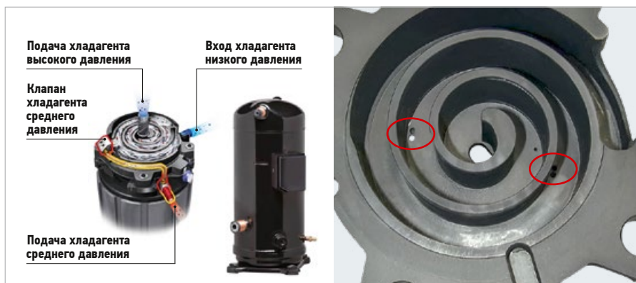
❖ Конструкция спиральных компрессоров с дополнительными отверстиями (показаны на правом фото) для подачи газообразного фреона среднего давления
