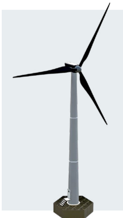
Рис. 4. Расчётная параметрическая 3D-модель ВЭУ 100 кВт для CAD
